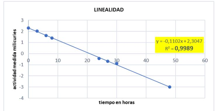
Figura 2: Gráfico de linealidad encontrando un coeficiente de 0.9989.
